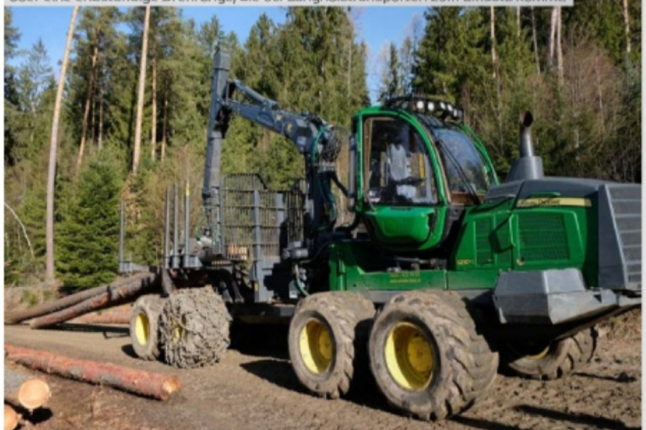
Einer von zwei John Deere 1210G-Forwardern in Diensten Martin Wilhelms. Dieser hier verfügt über eine endständige Drehrunde, die bei Langholztransporten zum Einsatz kommt.
