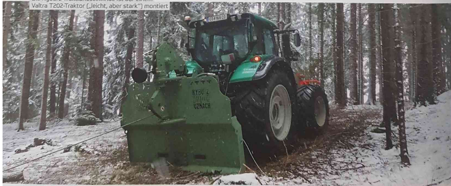
Die Kyburz-Traktionsseilwinde ist auf einem Valtra T202-Traktor („leicht, aber stark“) montiert
