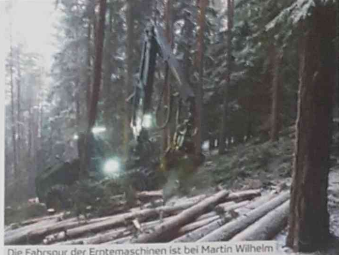
Die Fahrspur der Erntemaschinen ist bei Martin Wilhelm zur Bodenschonung immer dick mit Astwerk bestückt
